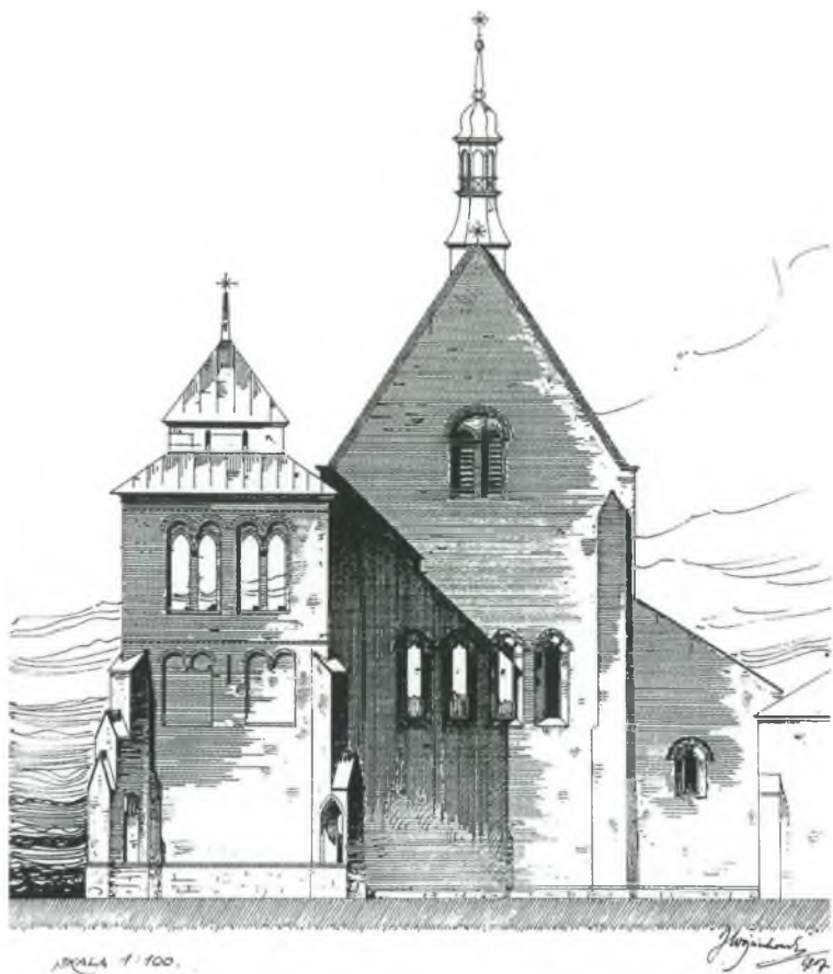
Projekt restauracji elewacji zachodniej kościoła Jarosława Wojciechowskiego z 1907 roku.
